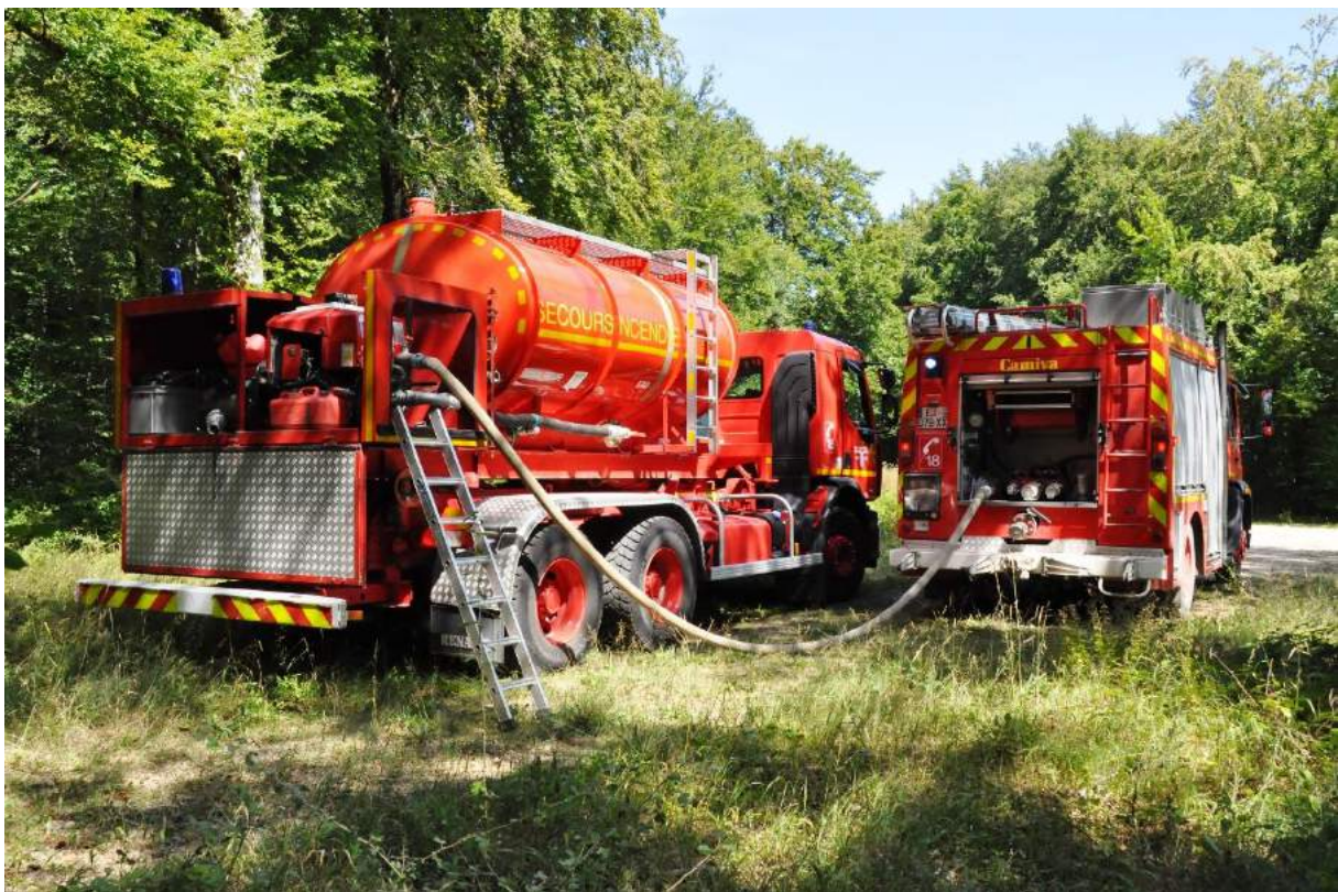
FIGURE 84 ALIMENTATION EN EAU D'UN FPT PAR UN CCGC
